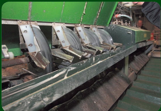
Via druppelaars loopt continu ontsmettingsvloeistof over de ronddraaiende messen.
